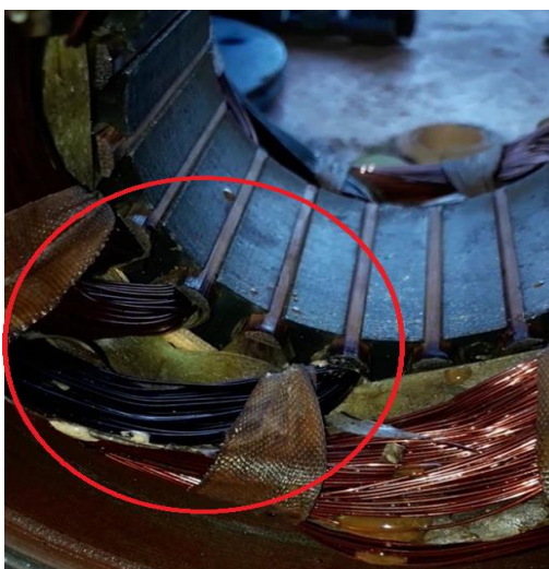
Рисунок 3 – Перегоревшая статорная обмотка асинхронного двигателя в результате перегрева подшипника при эксцентриситете ротора
