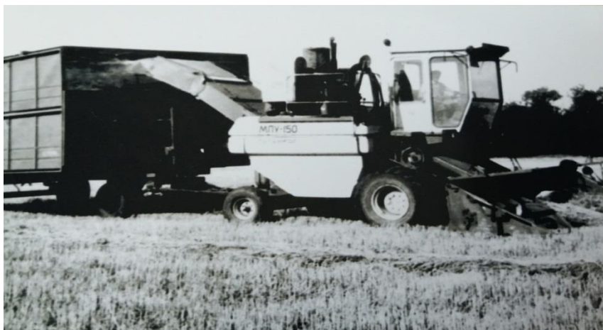
Рисунок 1- Полевая машина МПУ-150 на подборе валков рапса
