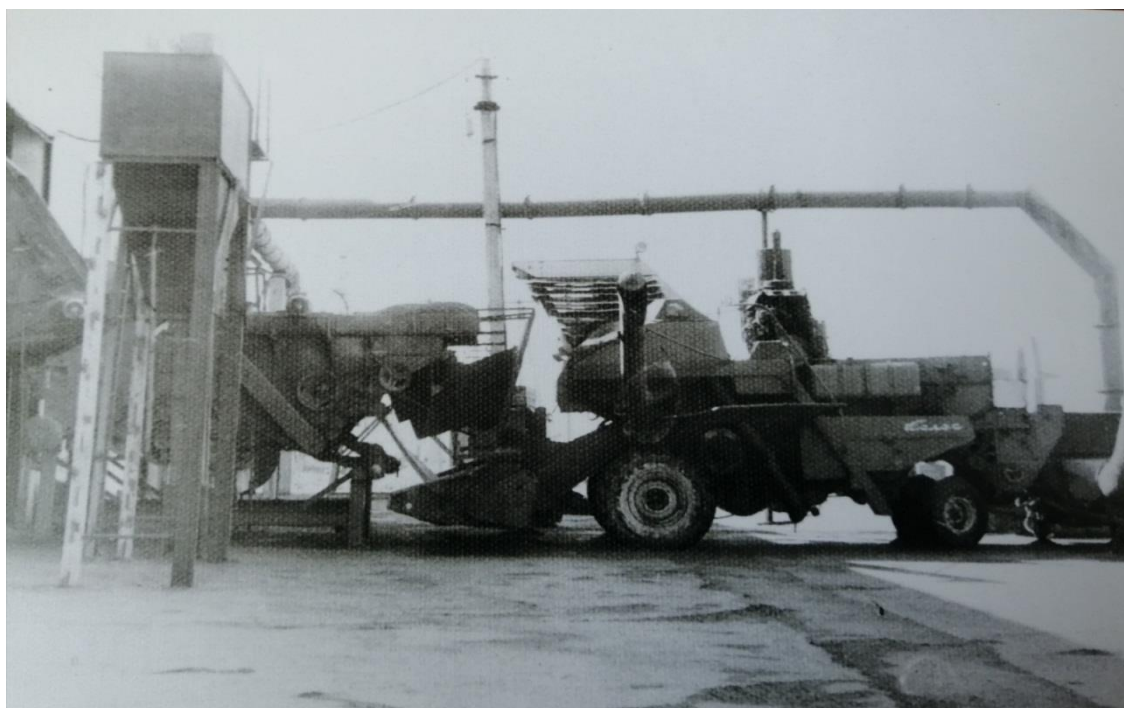
Рисунок 4- Стационарное оборудование по обмолоту рапса выполненное на базе рабочих органов зерноуборочных комбайнов (экспериментальный цех)
