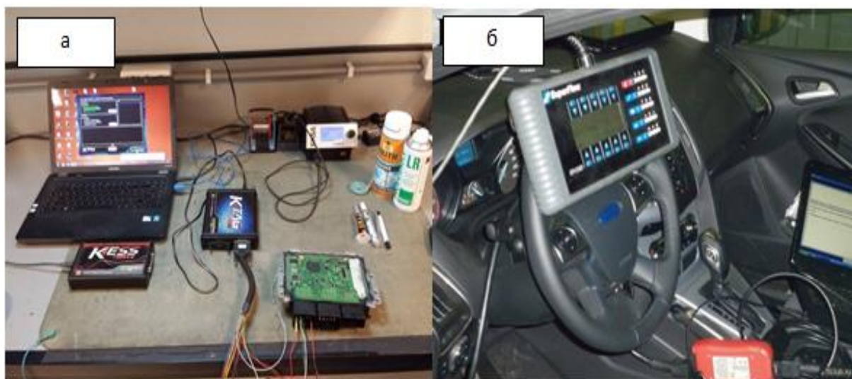
Рисунок 1 – Диагностика ЭБУ автомобиля: а – прошивка ЭБУ в лаборатории; б – диагностика через OBD-разъем
